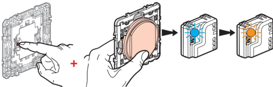
Tout en maintenant l'appui sur le bouton **configuration** de la commande sans pile, sans fils, appuyez **brèvement** sur le bouton **ON** ou **OFF** de la commande sans pile, sans fils, le voyant d'éclairage du micromodule s'allume en bleu puis revient en orange.
