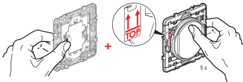
Tout en maintenant l'appui sur le bouton configuration, appuyez sur le haut du bouton de la commande sans pile, sans fils pendant 5 secondes.
